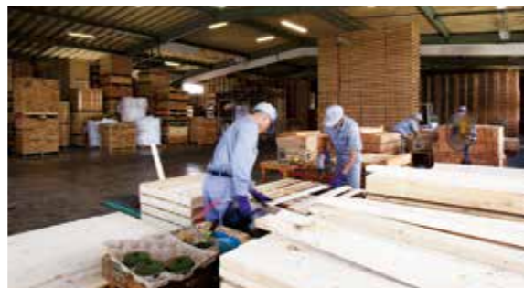
木製パレットの製造・修理、各種梱包、木箱・木枠の製造
